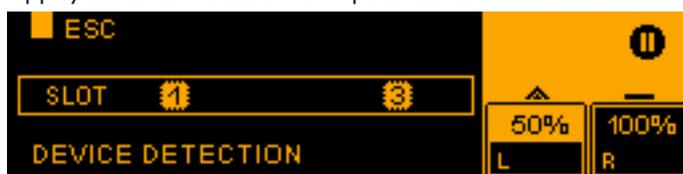
La détection d'appareils est effectuée et l'écran affiche les logements dans lesquels un appareil avec protocole de contrôle de médias a été détecté.
