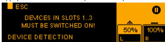
▶ Allumez les appareils ew G3 installés avant de démarrer la détection d'appareils.
